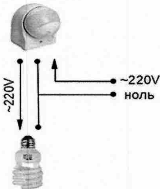
Рисунок схема подключения датчика движения
